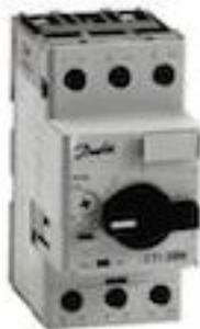
Автоматические выключатели СТИ служат для защиты электродвигателей от короткого замыкания и перегрузки и предназначены для значений токов 0.1-90А (нагрузка типа АС-3). Вся номенклатура этого типа продукции разделена на три группы. В первую группу вошли 13 выключателей серии СТИ 25М, предназначены для токов 0.1 - 25А.
